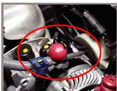
安裝於發電機正極線上支援電流迴路達到快速放電的效果
