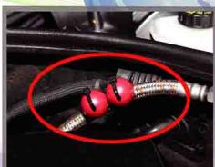
安裝於進油管，細化汽油分子增加霧化面積加速引擎降溫幫助燃燒效率
