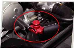
② T1 動力晶片 支援散熱水管
