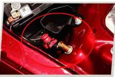
④T5動力晶片安裝電瓶負極
