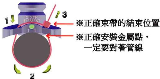
T5 動力晶片 正確安裝示意圖
