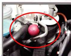
安裝支援動力方向盤油管可以減少磨耗延長機件壽命
