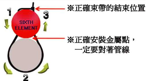
產品兩端的金屬點為測試產品有無故障的測試點(非接觸點)
