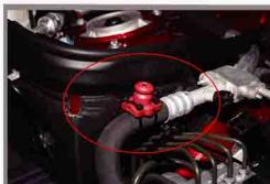
安裝於冷氣循環管路上使壓縮機輕載
